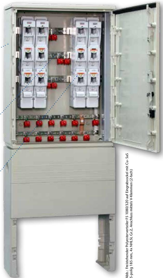
Abb.: Freistehender Polyesterverteiler FS 1080/320 auf Eingrabssockel mit Cu-S&S 5-polig 185 mm, 4x NH-LSL Gr.2, Anschluss mittels V-Klemmen (2-fach)
